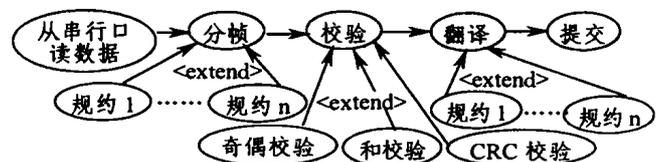
图1 串行口通讯的接收器 use case 图
