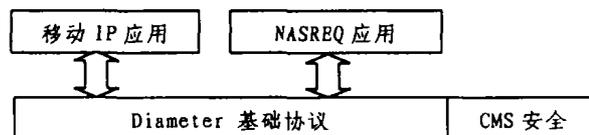
图3 Diameter 协议结构
