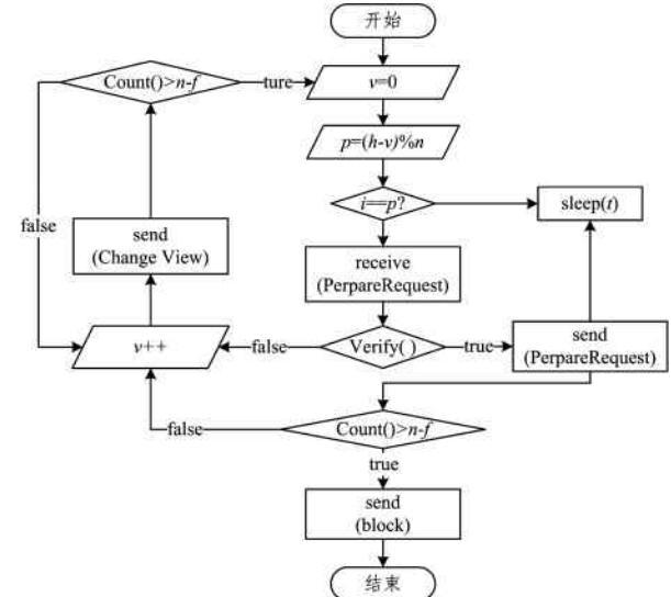
图 1 dBFT 算法的流程图
