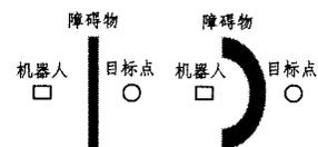
图2 移动机器人陷入极小值情况
