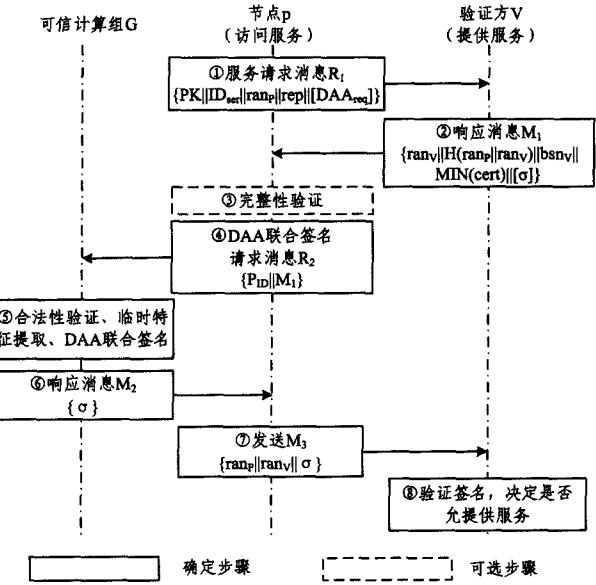
图 2 异构平台节点认证流程图
