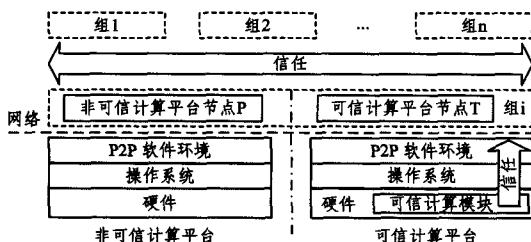
图1 基于可信计算的分布式异构网络信任模型
