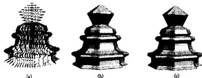
(a) 输入的散乱数据;(b) 用传统水平集方法重构的曲面;
