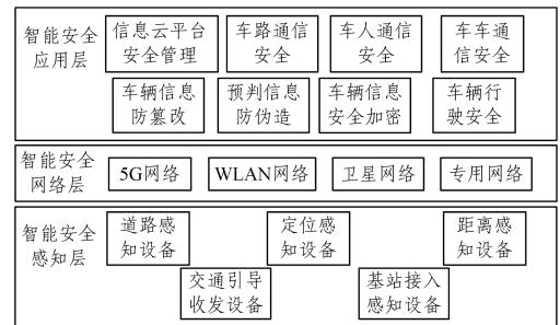
图9 5G智能安全车联网框架图
