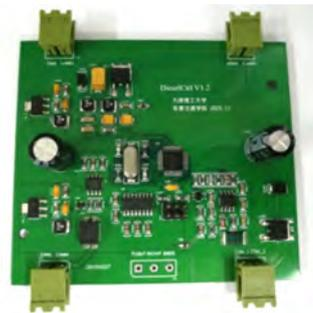
图 3 喷油器驱动模块
