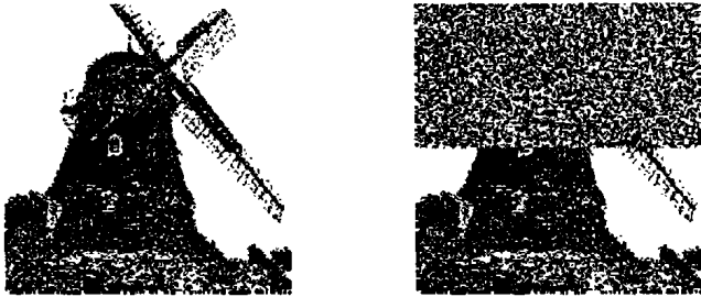
图2 左图为未嵌入任何信息的图片的可视攻击效果图,右图是用 EzStego 嵌入占图像大小 50% 的信息后图像的可视攻击效果图
