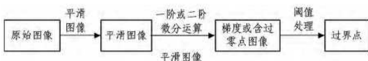
图 3 边缘检测的一般过程
