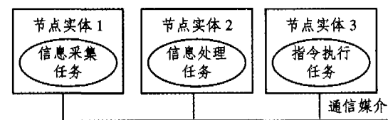
图 1 分布式测控系统的典型结构模型
