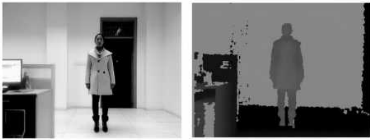
(a) Kinect 摄像头获取的彩色图像 (b) Kinect 摄像头获取的深度图像
