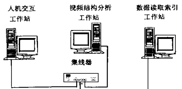
图 2 分布式视频结构解析工具的硬件结构
