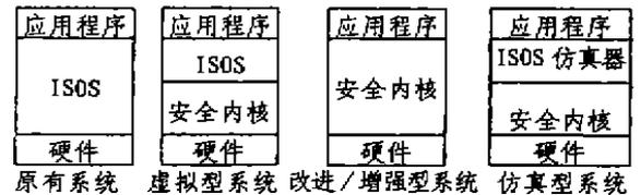
图1 安全操作系统开发方法
