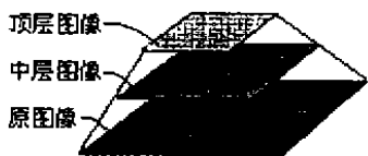
图 3.16 原图像经变换(1)后所形成的分层图像示意图
