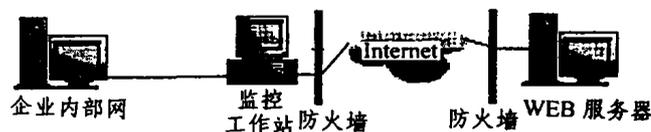
图2 监控系统的拓扑结构
