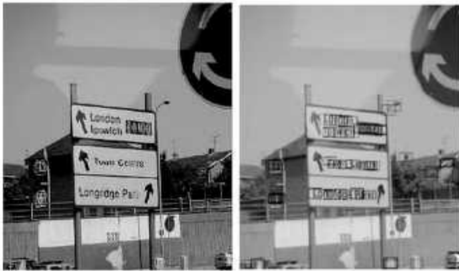
图1 几何过滤后的MSER(左)和粗提取的输出(右)
