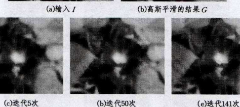
对(a)应用高斯滤波( \sigma=10 )得到(b)。以(a)(b)为输入,应用本文算法迭代不同次数得到(c)(d)(e)。参数 \kappa=1.05 。(d)和(e)几乎相同,表明算法已经收敛。
