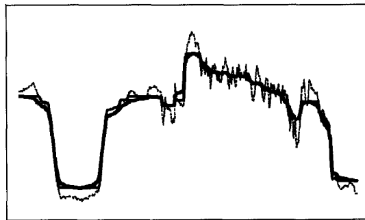
其中虚线表示原始信号,细实线为本文方法的平滑结果,粗实线为 WLS 滤波器平滑的结果
