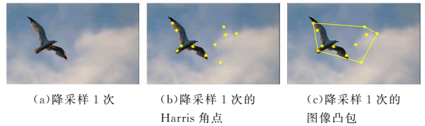
图 4 基于一次降采样的图像凸包计算
