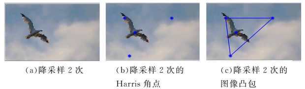
图 5 基于二次降采样的图像凸包计算
