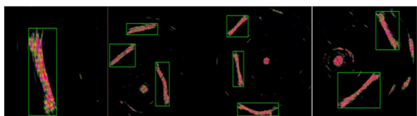
图 10 声呐图像木桩检测图
