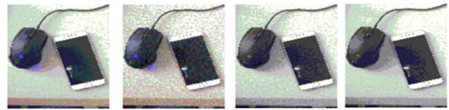
(a)原图像 (b)添加噪声后的图像 (c)3 * 3 邻域的纳滤波后的图像 (d)7 * 7 邻域的纳滤波后的图像
