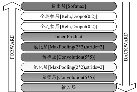
图 4 CNN 网络结构
