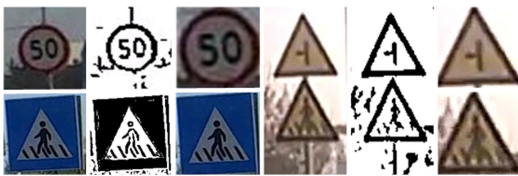
图5 基于形态学的候选区域定位结果
