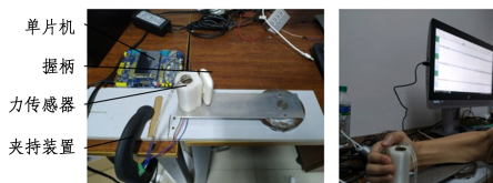
图 2 肌电信号采集装置
