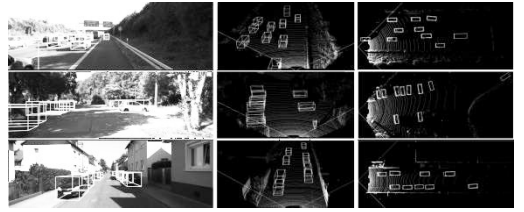
注: 为了更好地可视化, 第一列将三维检测框映射到图像上; 第二列和第三列为在点云三维视角和鸟瞰视角的三维检测结果
