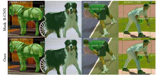
图 2 本文方法和 Mask R-CNN 的实例检测和分割结果对比
