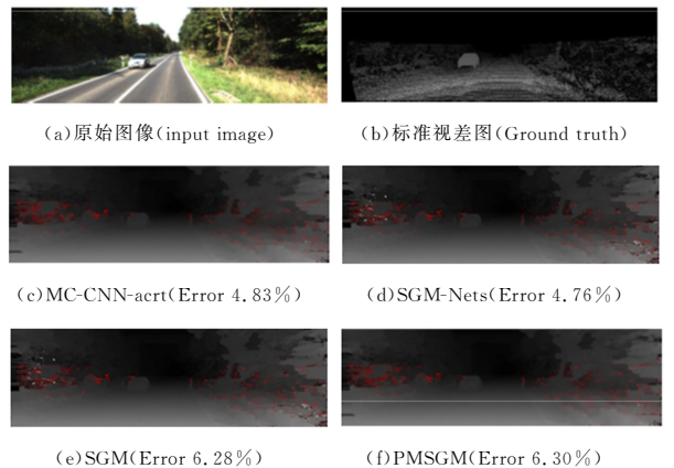
图 5 KITTI2015 数据集上视差图的质量比较(电子版为彩色) Fig. 5 Disparity image quality comparison on KITTI2015 dataset
