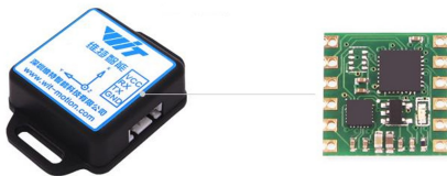
图 1 WT901C 数字姿态传感器示意图
