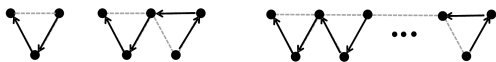
图 14 基于等边三角形的悬停方案下, m 为奇数且奇数列和偶数列的网格个数不同时, 第 2 列和第 3 列的连接方式
