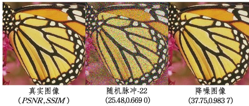
图 9 MA-UNet 对随机脉冲噪声图像的降噪效果
