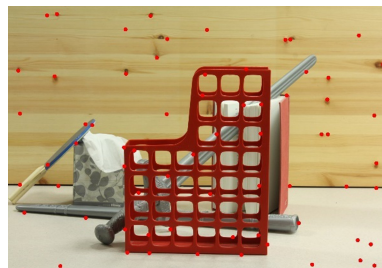
图 4 优化 ORB 算法在同一室内场景中特征点提取结果
