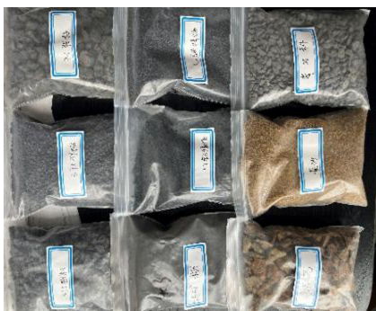
图 1 混凝土砂石骨料样本
