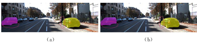
图 2 基于 RGB 引导的 Mask 边缘优化
