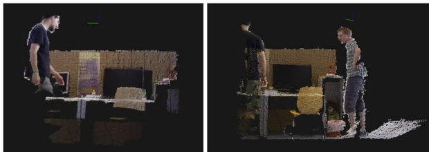
图 5 由视差图转换得到的三维点云
