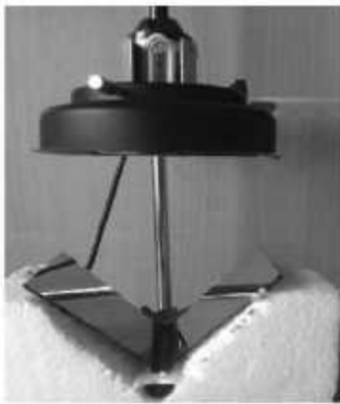
图 7 单目多视角立体视觉装置原型
