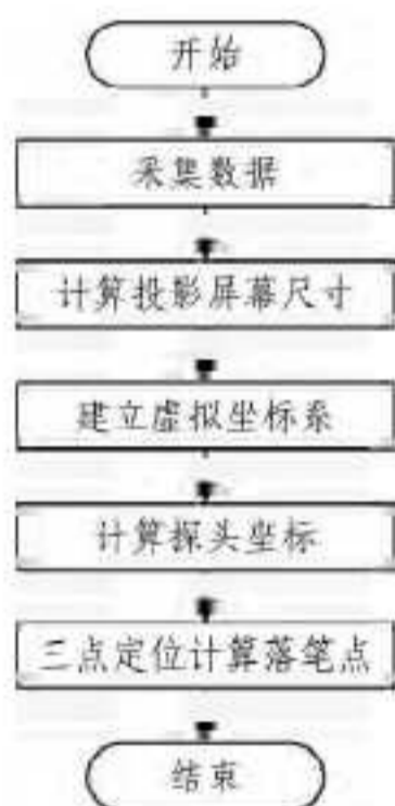
图 2 九点校准进化算法流程图
