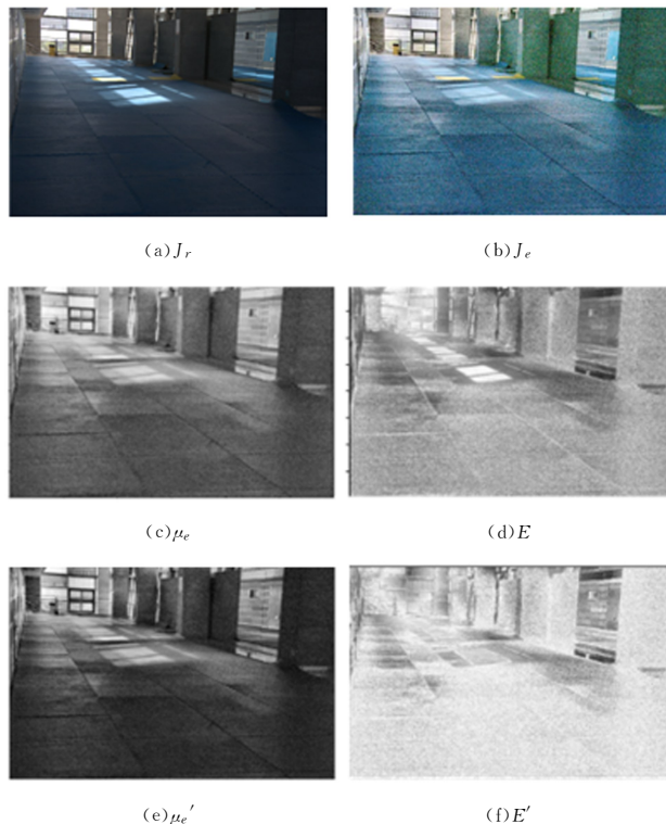
图 4 修正前后的低照度增强图像与参考图像的残差图
