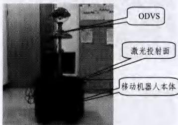
图6 基于主动全景视觉的移动机器人
