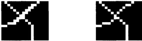
(a) 细化后局部放大图 (b) 单一像素化后局部放大图
