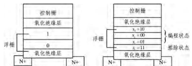
图 1 闪存单元结构示意图
