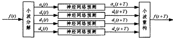
图 3 “松散型”小波神经网络模型结构
