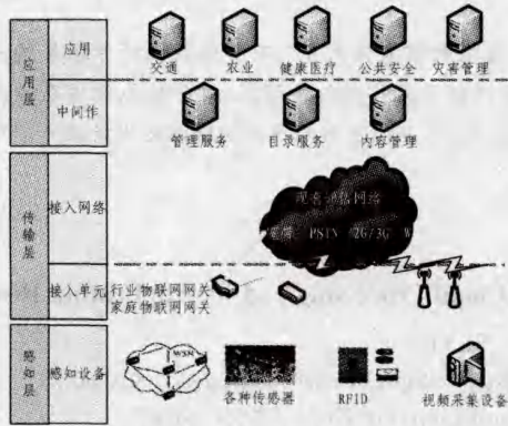
图2 基于改进的3层物联网体系架构
