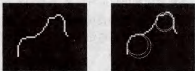
(a) 边缘弧线段 (b) Hough 检测结果
