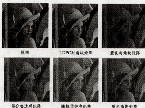
图 5 5 种不同观测矩阵对 Lena 图像重构后的效果图
