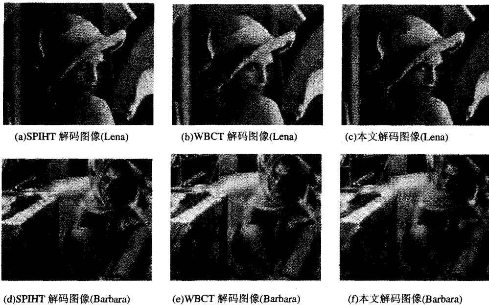
图 11 三种压缩算法重构图像的比较(0.07bpp)
