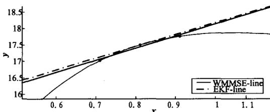
图 1 EKF 法得到的近似直线和 WMMSE 法得到的近似直线(实线为 WMMSE 法得到的线性化直线,虚线为 EKF 法得到的线性化直线)
