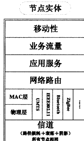
图2 节点实体协议层次模型
