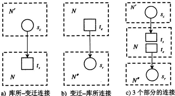
图 4 分块建模时各个子网的几种常见连接方式
