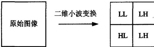
图 1 二维小波变换结构示意图
