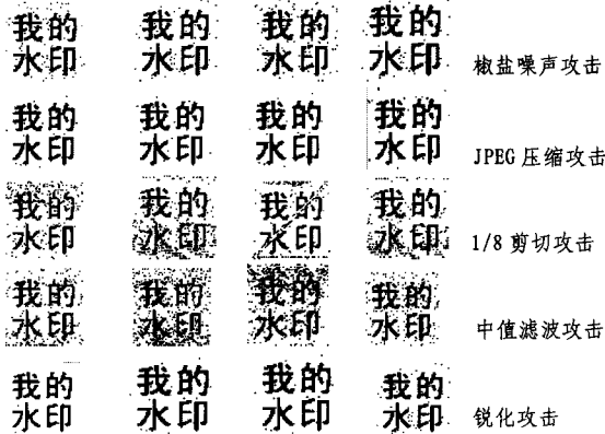
图4 各种攻击后提取出的水印图
