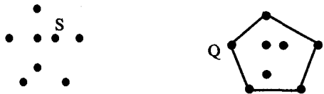
A) 木版上各点处各钉一个图钉: B) 外围缠绕各图钉所得橡皮带围: 二维点集 S 凸壳 Q
